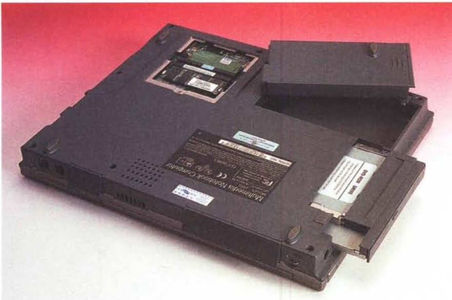
Dal fondo del notebook si accede al pacco batterie, mentre uno sportellino cela lo slot di espansione della memoria.
